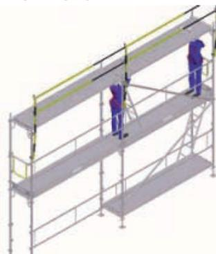
**9|** Desmontaje de las diagonales.
