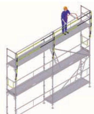
**8|** Una vez desmontado todo el nivel descender al nivel inferior por la escalera. Desmontaje de las plataformas y la plataforma con trampilla del nivel superior desde el nivel inferior.
