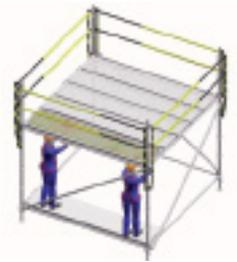
**22** Desmontar los montantes y barandillas de seguridad.
