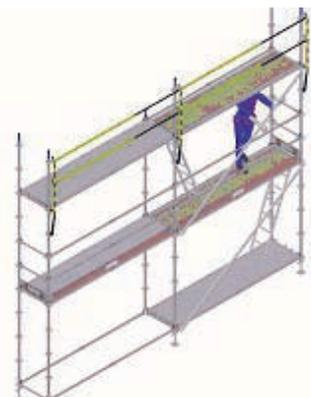
9| Desmontaje de las plataformas y la plataforma con trampilla del nivel superior desde el nivel inferior.
