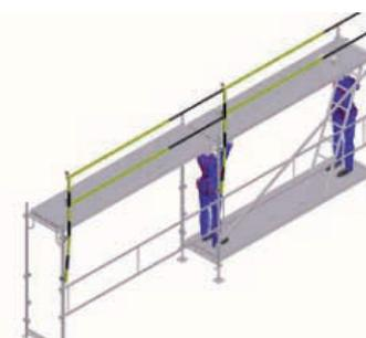
**19** | Soltar el montante de seguridad del extremo del nivel de plataforma superior.
