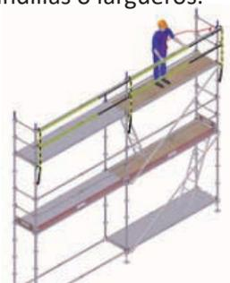
8| Una vez desmontado todo el nivel descender al nivel inferior por la escalera. Desmontaje de las diagonales.
