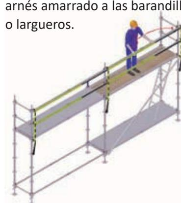
**19** Una vez desmontado todo el nivel descender al nivel inferior por la escalera. Desmontaje de las plataformas y la plataforma con trampilla del nivel superior desde el nivel inferior.
