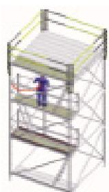
**5|** Desmontar la plataforma con trampilla. Esta plataforma se manipulará entre dos personas.
