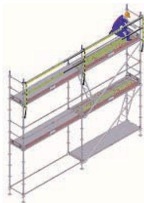
**26** Desmontar y retirar los montantes y las barandillas de seguridad.
