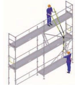
**4|** Colocación del montante de seguridad con los barandillas de seguridad en el nivel superior.
