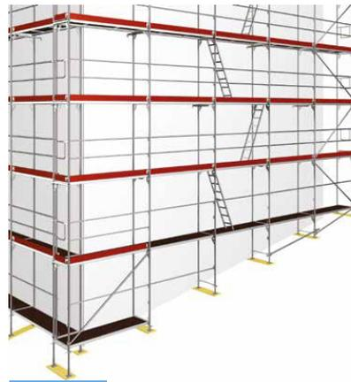
Nunca se deben utilizar elementos frágiles para salvar desniveles, como por ejemplo, palés, bovedillas, ladrillos y, en general, elementos inestables. Se utilizarán únicamente los accesorios homologados por el fabricante como componentes del andamio. Es recomendable utilizar bases con husillo de regulación, apoyadas sobre tabloncillos de reparto de cargas.
