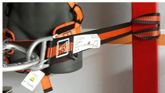
Enganche rápido textil conforme a la EN 795.
