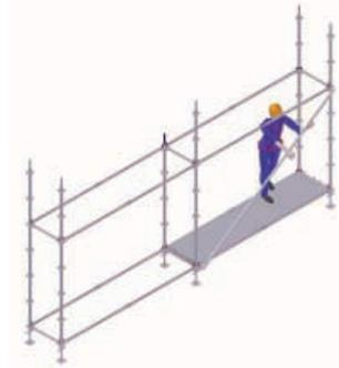
**11|** Colocar los montantes de seguridad con las dos barandillas en los montantes exteriores.
