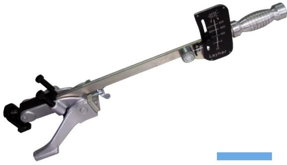
La resistencia del taco fijado se comprobará mediante medios mecánicos, como el comprobador mecánico de anclajes, aparato diseñado para determinar la resistencia al arranque y, en su caso, la carga de rotura y el cono de material arrancado por el fallo de un anclaje mecánico o químico.
