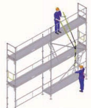
**24** Desmontar y retirar los montantes y los barandillas de seguridad.
