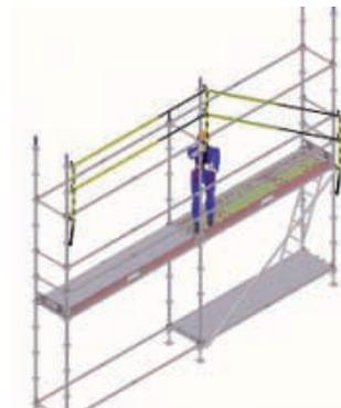
**13** | Colocar el conjunto del montante de seguridad con barandillas de seguridad en el siguiente montante.
