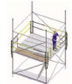
**16** Cerrar las barandillas interiores de la plataforma con trampilla. Colocar los montantes y barandillas de seguridad en el nivel superior.
