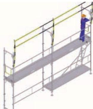
**11** | Montar el montante de seguridad del extremo en el nivel inferior.
