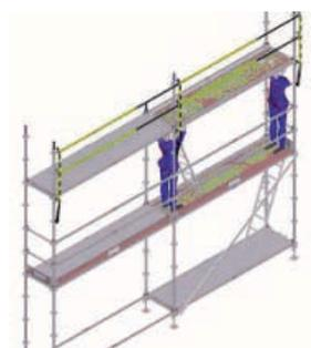
**10** | Soltar el montante de seguridad del extremo del nivel de plataforma.
